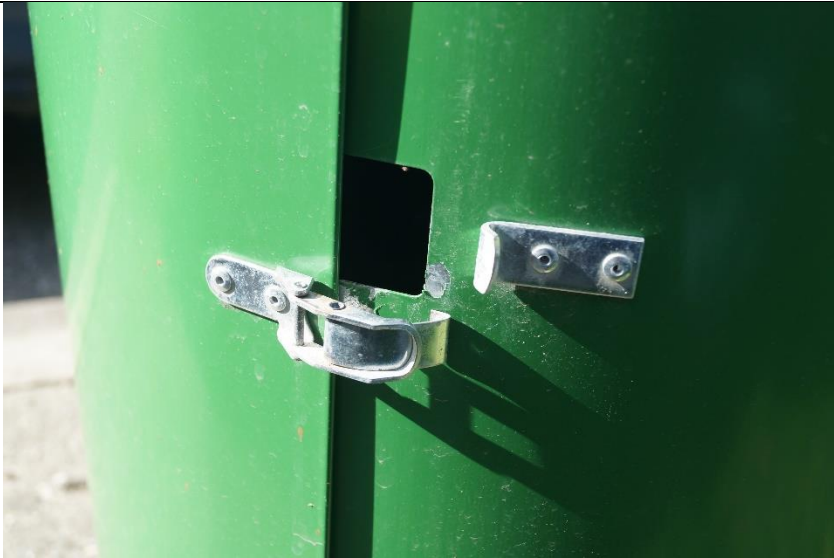
Mülleimer wird nur über diesen Verschlussmechanismus geöffnet – hier deutlich verzogen
