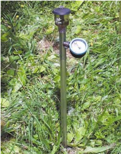
Tensiometer zur Messung der Bodenfeuchte
